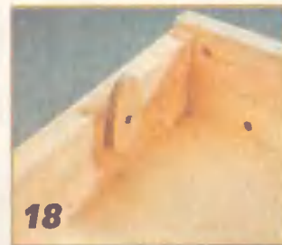
18 К задней стенке ящиков крепят поворотные стопоры. Чтобы полностью вытащить ящик, надо поставить стопоры в горизонтальное положение.
