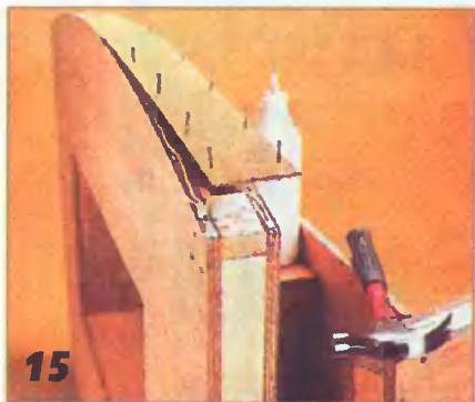
На полукруглую верхнюю кромку задней стенки наклеили накладку из 3-мм ДВП, которая скрыла торцевые срезы фанерных панелей обшивки.
