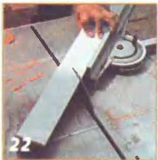
22 Размеченные нащельники с помощью настольной дисковой пилы раскраивают по длине и зашлифовывают их «на ус».
