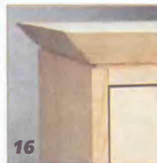
16 Декоративный паз между корпусом серванта и полкой-крышкой создают подкладыванием под нее дистанционных планок.
