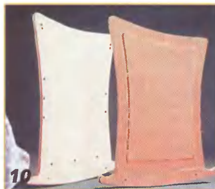
10 Прежде чем приступать к сборке, переднюю и заднюю стенки соединяют на клею и шкантах с полозьями.
