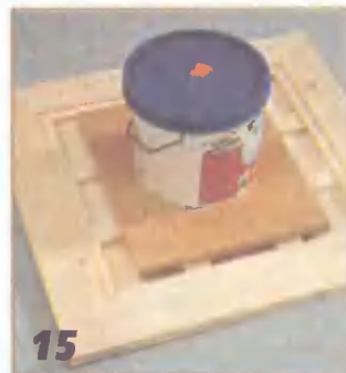
15 Сформированную решетку временно, пока не затвердеет клей, нагружают каким-нибудь тяжелым предметом.
