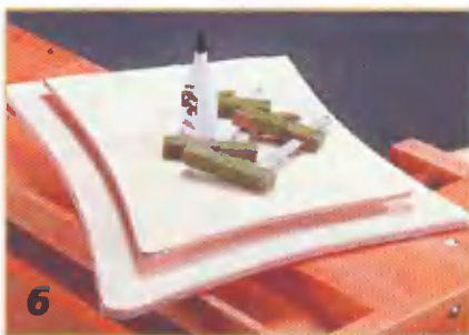
6 Декоративные накладки из многослойной фанеры толщиной 15 мм наклеивают точно посередине передней и задней стенок, используя для крепления несколько струбцин.
