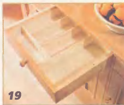
19 Кассетная вставка для столовых приборов расположена в передней части ящика. Вместе с содержимым — это немалый груз. Чтобы избежать случайного выпадения ящика, необходимо его застопорить.
