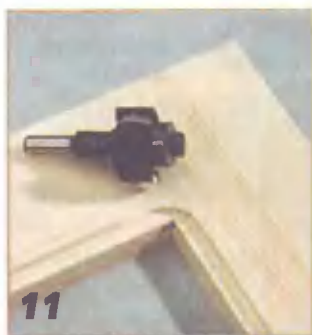
11 На плоских шкантах с клеем соединяют и детали рам дверец. Фальцы на внутренних кромках рам выбирают фрезой с упорным кольцом.
