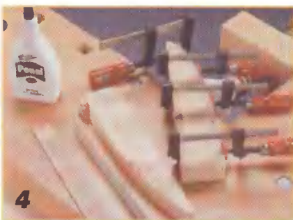
4 Балясины выклеивают из двух одинаковых заготовок толщиной 4 мм. Одновременно с помощью шаблона придают балясинам небольшую кривизну, прижав их струбцинами на время высыхания клея.
