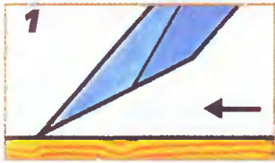
Фаска ножа заточена под углом 25^\circ . Угол резания рубанка для чистовой обработки — 45^\circ .
