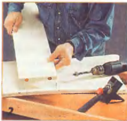
В боковых стенках по меткам, оставленным специальными маркерами, сверлят отверстия под шканты. Для сверления желательно использовать сверло с упором-ограничителем и кондуктор.
