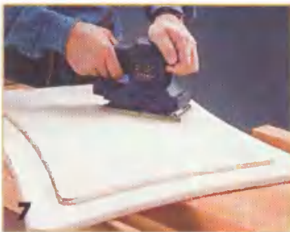
7 Когда клей схватится, панели тщательно шлифуют с помощью виброшлифовальной машинки.
