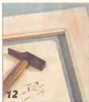
12 Филенку, углы которой скругляют в соответствии с закруглениями фальцев, крепят к раме гвоздиками.
